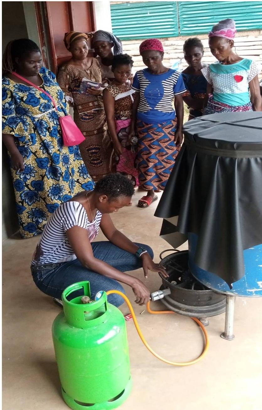
**Das Ende der Maiskolbenzubereitung wird durch das Aufquellen der Plane angezeigt, die als Abdeckung zum Schutz des Dampfes dient**
